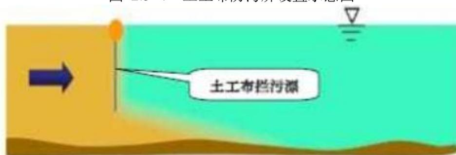
图 2.5-5 土工布防污屏防污机理示意图
